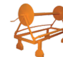
УСТАНОВКА ДЛЯ РАСКЛАДКИ ЗАЩИТНОГО ПОКРЫТИЯ
