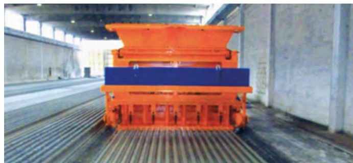
МАШИНА T-20 (МАКСИМАЛЬНАЯ ШИРИНА ИЗДЕЛИЯ – 2,4 м)
